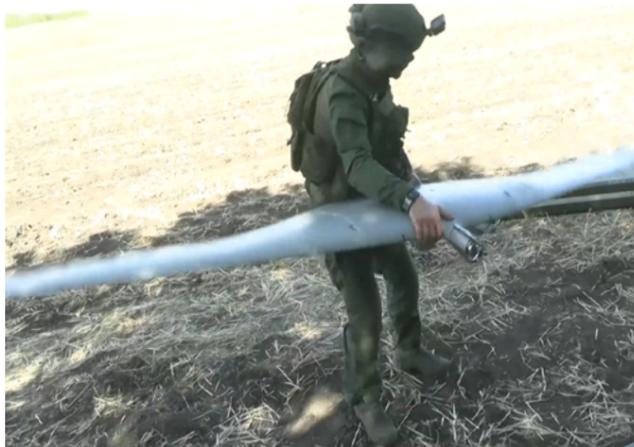
крыльев - более 3-х метров. Он способен залететь глубоко в тыл к противнику на расстояние до 70 километров, благодаря электрическому двигателю - он практически бесшумный, а установленная камера - лучшая в своем классе, может находиться в небе до 4-х часов.
